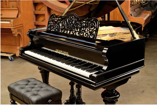
Abb. 3 ◀ Flügel des Herstellers Carl Mand, Koblenz, von 1904. Das Gehäuse wurde nach traditioneller Technik mit Schellack, Bimsstein und Nigrosin lackiert. © Mit freundl. Genehmigung von J. Rothe 2016, all rights reserved)
