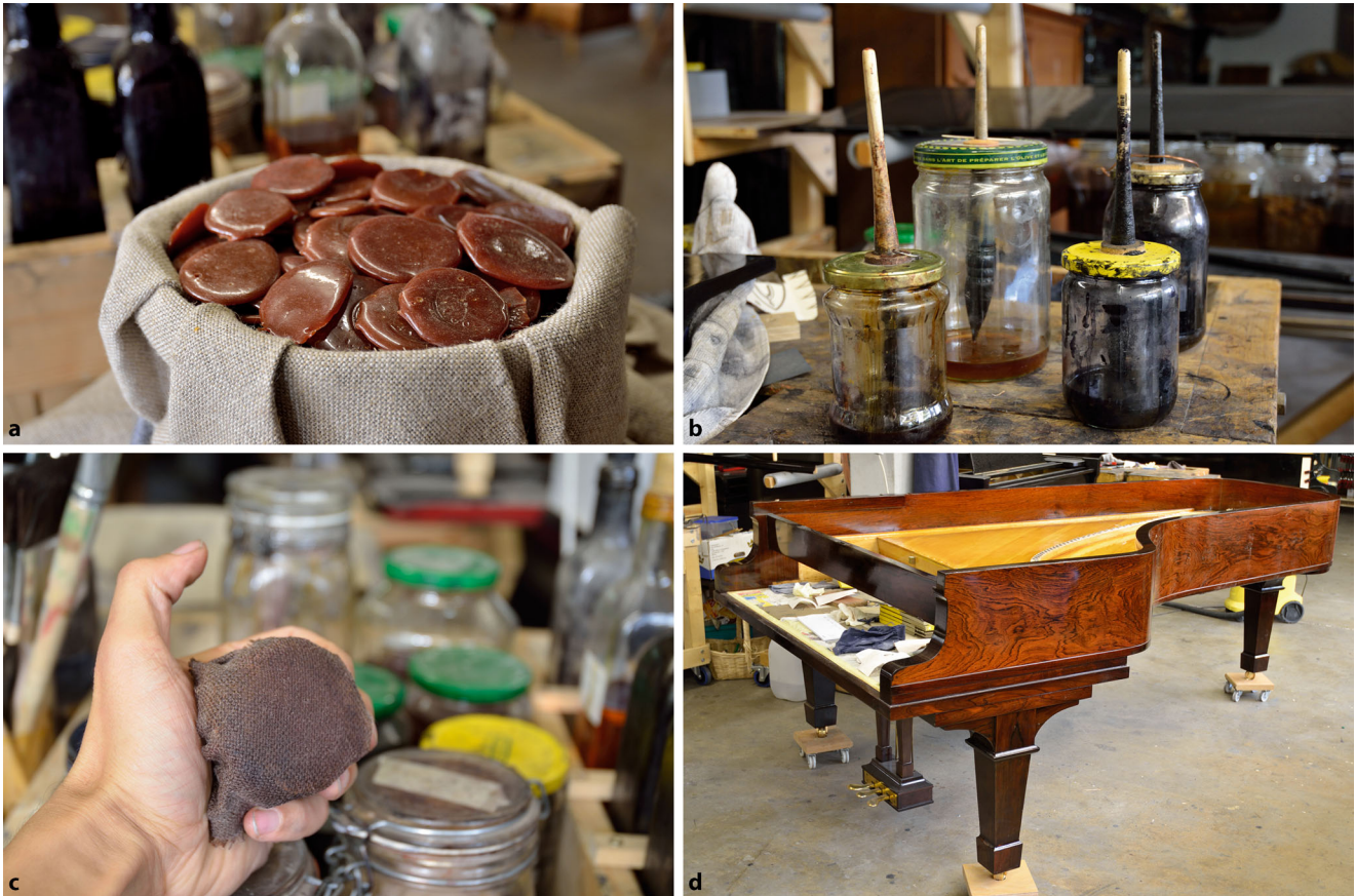
Abb. 4 ▲ Lack. a Schellack, hier in Form von Knopflack, wird aus dem Kokon einer Schildlaus gewonnen; b Fehhaarpinsel lagern im Lack; c typischer Polierballen zum Auftragen der Schellackpolitur; d Rio-Palisander mit Lack aus Kopal. (© Mit freundl. Genehmigung von J. Rothe 2016, all rights reserved)
